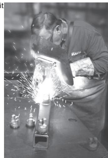
La soudure doit être exécutée uniquement par un soudeur diplômé, selon la norme DIN EN ISO 9606-1. Procédure de soudage:
