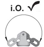
7. Les anneaux de levage doivent pouvoir pivoter librement sur la construction à lever. De même, les crochets et anneaux doivent pouvoir pivoter librement et ne doivent pas pouvoir s'abîmer contre des arêtes.
